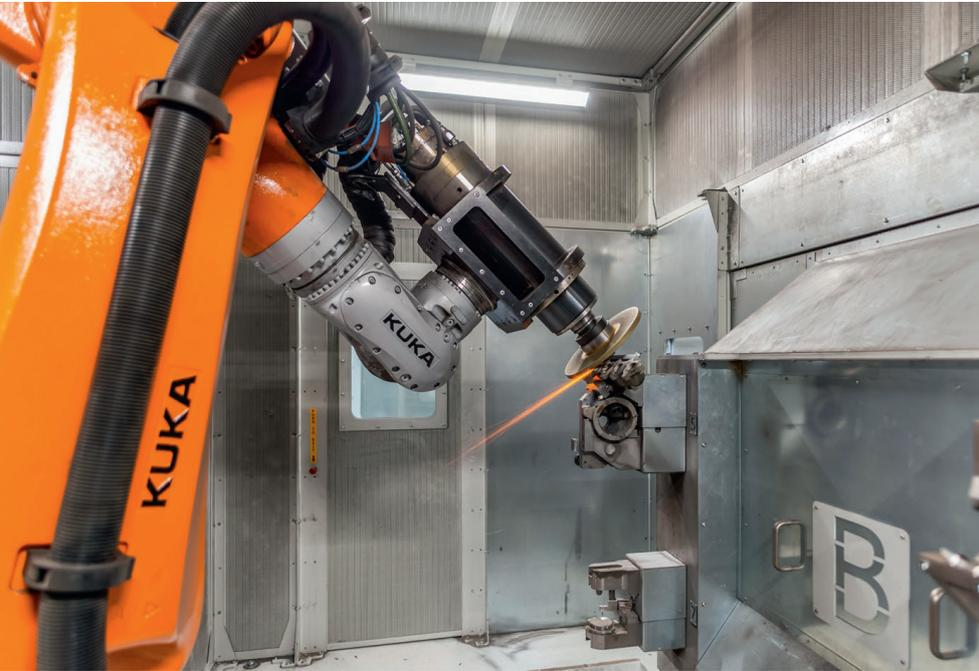
2 Der Schutz vor Stäuben und Spänen ist dank der Foundry-Ausführung der Roboter, die mit hitze-, korrosions- und säurebeständigen Lackierung sowie extra Dichtungen aufwartet, gut gegeben (© Kuka)
